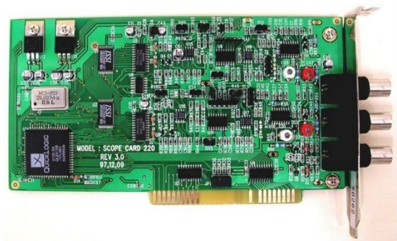
„Scope Card 220” oszcilloszkóp kártya
