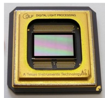
Vetítőkben alkalmazott DMD-chip
