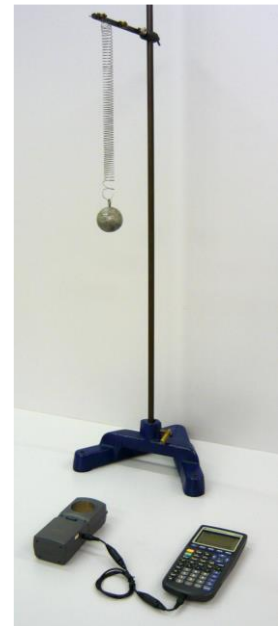
Kísérleti összeállítás rezgések vizsgálatához
