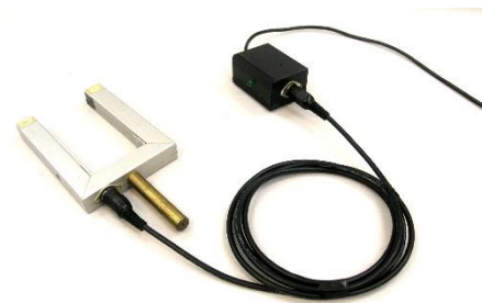
Fénykapu-interfész egység kinematikai kísérletekhez
