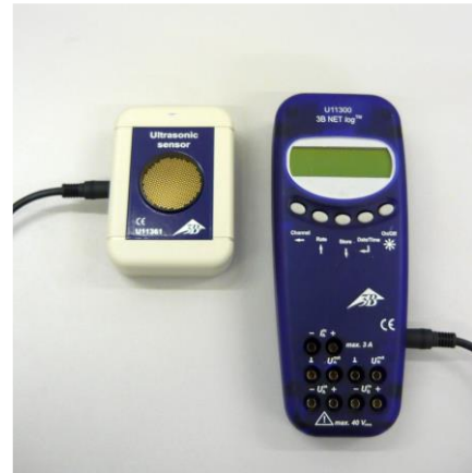
A 3BNETlog adatgyűjtő a hozzá csatlakoztatott ultrahangos szenzorral
