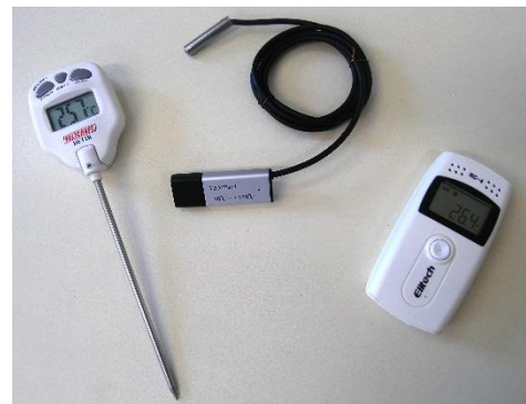
Hőmérők: LCD kijelzésű, TEMPer1 USB hőmérő, Elitech RC-4HC USB adatgyűjtő
