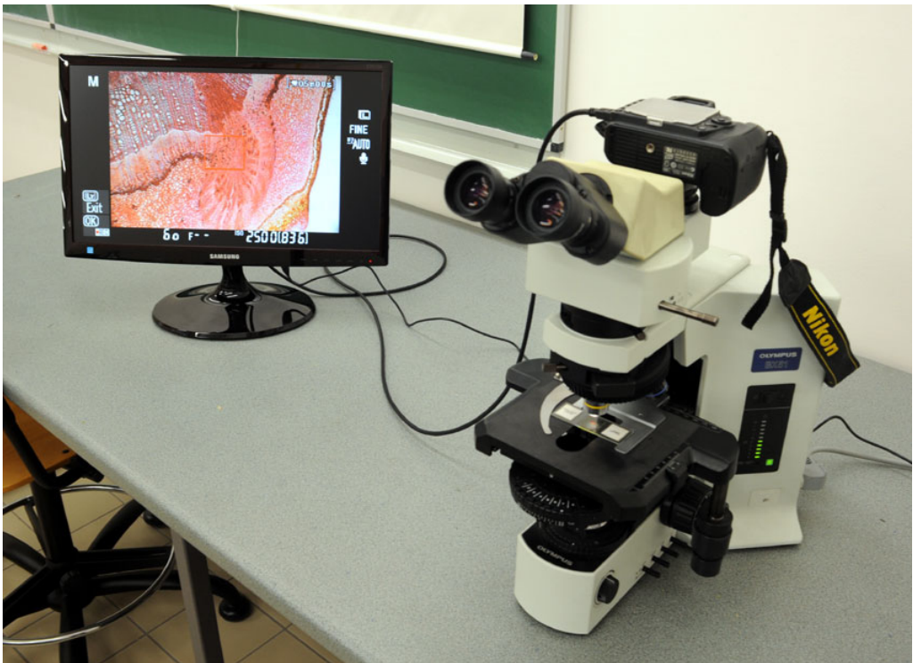
Összekapcsolt fénymikroszkóp, fényképezőgép és monitor
