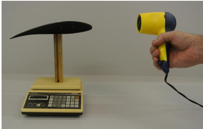
11. ábra. Szárnyprofilra ható felhajtó erő egyszerű demonstrációja.
