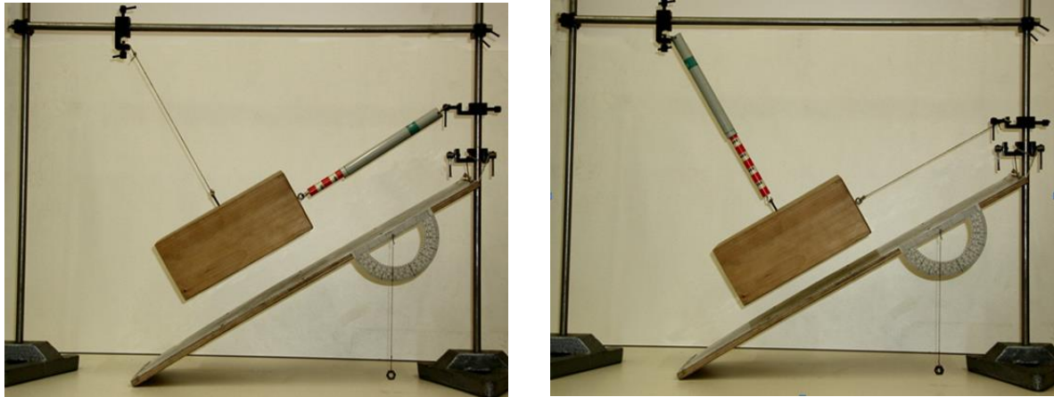
7. ábra. Lejtő helyettesítése rugós erőmérővel.
