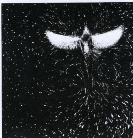
▲ 13/a ábra. Repülő madár szárnyvégi örvényei (a vékony vonalak örvényfonalak). A szárnycsapások következtében ez az összecsavarodott örvénycső hullámos vonalat alkot, amint a Leedsi Egyetem kutatóinak számítógépes szimulálása mutatja
