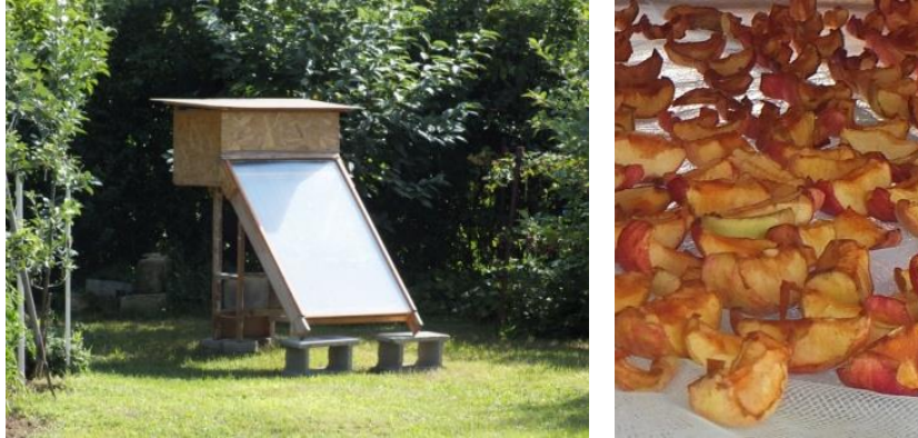
8. ábra. Házi készítésű napenergiás aszaló és a vele szárított gyümölcsök.
