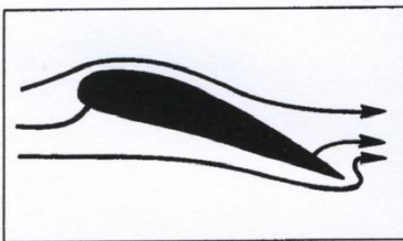
1. ábra. A szárnyat körülfoló áramlás közvetlenül a gép startolása után (még a kifutópályán). A szárny elkeskenyedő kilépőélét a levegőnek körbe kell áramolnia. Ez a hirtelen irányváltás nagyobb sebességek mellett már nem tud stabilan fennmaradni
