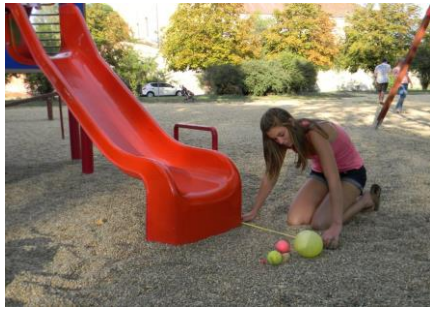
9. ábra. Vízszintes kifutású csúszdán leguruló labdák földet érési távolságának vizsgálata (bal). Mérleghinta egyensúlya (jobb).
